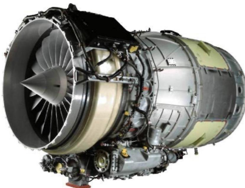
Рис. 1. Турбовентиляторный двигатель с тканой защитой модели AS907, корпорации Honeywell
